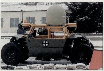
Versuchsträger des unbemannten Roboterfahrzeuges «Gecko».
