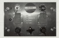
Übertragungsstation für Fiberoptik-LAN / MAN mit Energieversorgung
