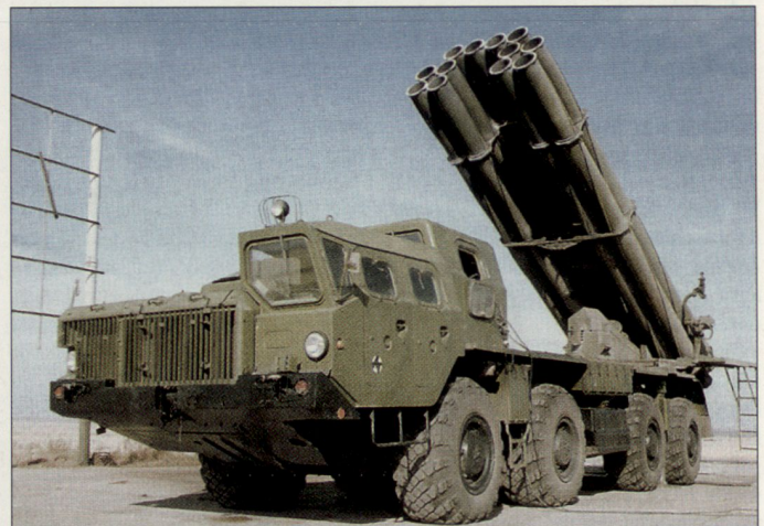
Mit den neuen verbesserten Raketen verfügt der schwere Mehrfachraketenwerfer vom Kaliber 300 mm «Smerch» über eine Reichweite von 90 km.
