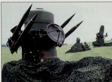
Die Systemkomponenten von RAPIER: Lenkwaffenwerfer, Richt- und Bediengerät, Folgeradar. Fotos: Luftwaffe
