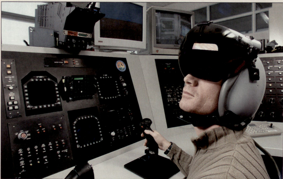
Im Avionik-Labor der RUAG Aerospace in Interlaken werden Tests mit dem neuen Helmvisier durchgeführt.
