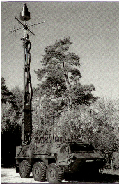
Mobiles Störsystem «Hummel» auf einem Schützenpanzer «Fuchs» bei der deutschen Bundeswehr.
