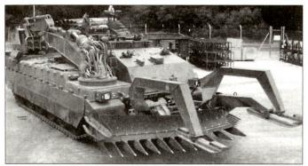
Britischer Geniepanzer «Trojan», ausgerüstet mit Minenräumgeräten.
