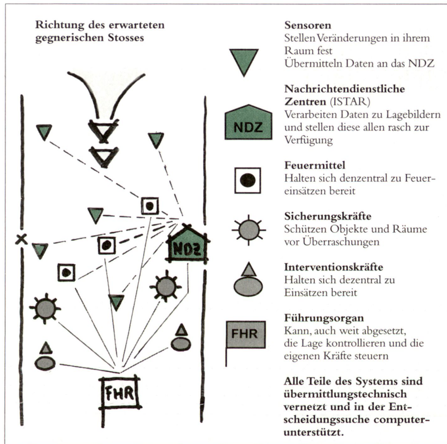
Vereinfachte schematische Darstellung C4ISTAR-System.
