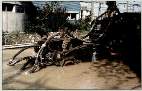
Löschwasserpumpen im Einsatz.
