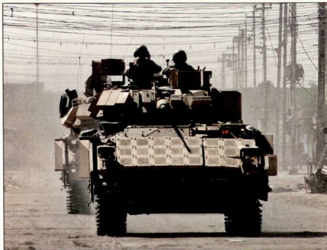
Kampfschützenpanzer Bradley M2A3, ausgerüstet mit Reaktivpanzerung beim Einsatz im Irak.
