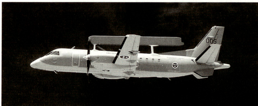
Die schwedische Luftwaffe verfügt über Airborne Early Warning (AEW)-Flugzeuge. Die S 100 Argus kann tief fliegende Ziele über weite Distanzen entdecken. Zudem sind diese Flugzeuge in modernen Konfliktszenarien weniger verwundbar als bodengestützte Radarsysteme. Die AEW-Fähigkeit war besonders wichtig, um einem begrenzten strategischen Angriff aus der Luft begegnen zu können.
