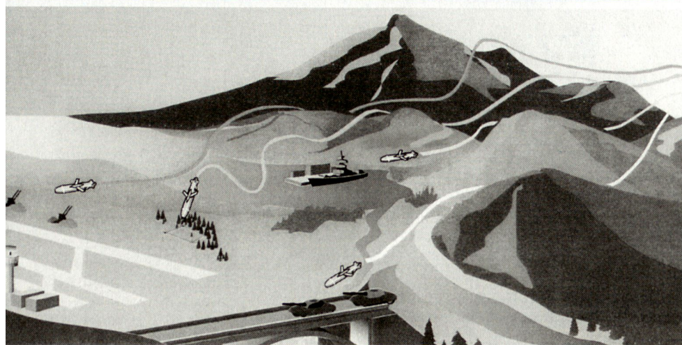
Typische Einsatzmodi von modernen LACM: Konturenangepasster Tiefstflug mit anschliessendem horizontalen Zielüberflug (Zünder auf «Airburst») gegen weiche oder halbharte Ziele; Pop-up und senkrechter Sturzflug gegen sehr harte, verbunkerte Ziele; Dive-Attack gegen Hafenanlagen, Brücken und andere Infrastrukturziele.
