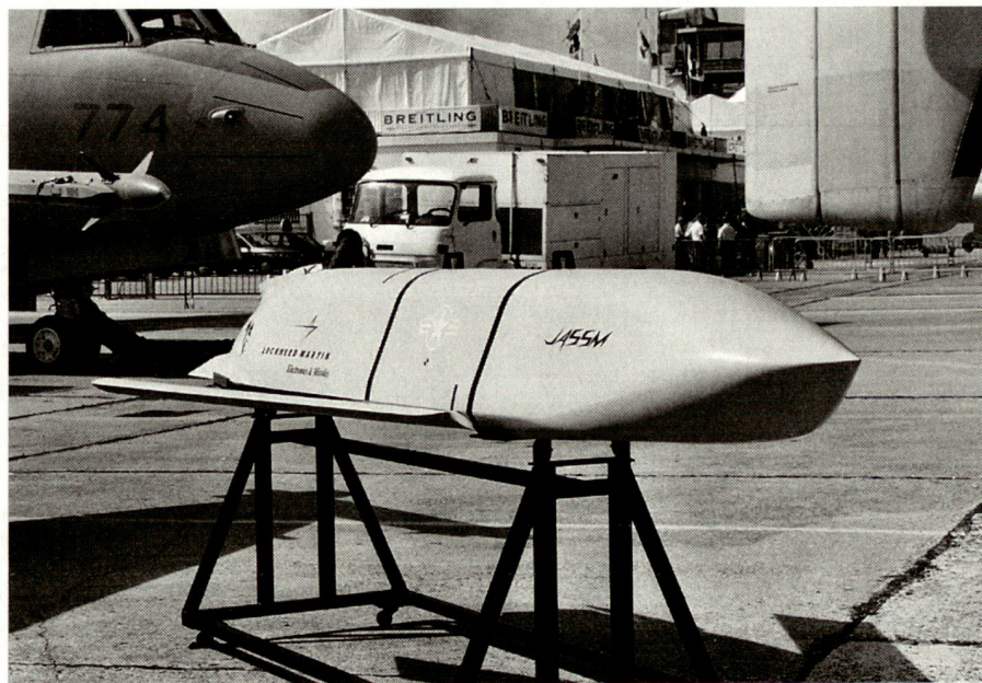
Die JASSM ist zusammen mit der AGM-129A wohl jene LACM, bei welcher die Stealth-Kriterien bisher am radikalsten umgesetzt wurden. Die Formgebung und die extrem glatte, kantenlose Oberfläche sorgen dafür, dass ihr RCS um mehrere Grössenordnungen kleiner ist als jener eines gewöhnlichen Kampfflugzeugs. Foto: Autor
