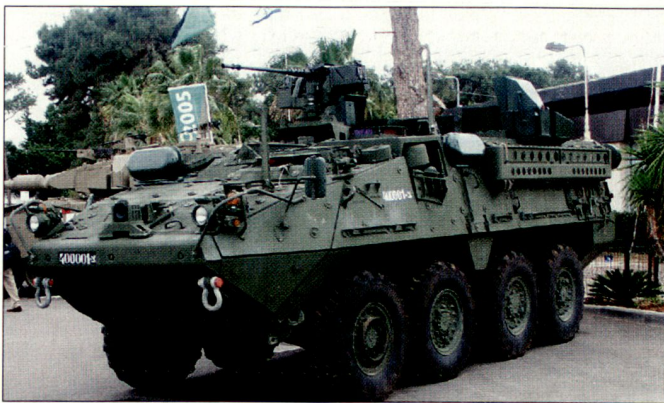
Schützenpanzer «Stryker», ausgerüstet mit dem aktiven Schutzsystem «Trophy».
