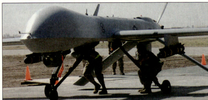
Unbemannter Aufklärungsflugkörper MQ-1 «Predator», ausgerüstet mit zwei Lenk Waffen «Hellfire».
