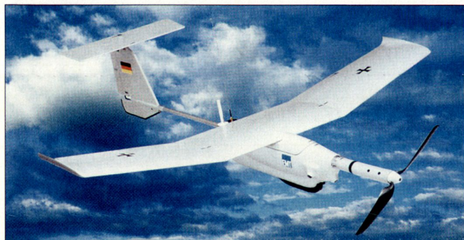
Die elektronisch angetriebene Minidrohne «Aladin» soll v.a. bei Auslandseinsätzen zum Einsatz gelangen.
