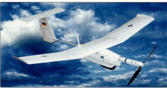
Die elektronisch angetriebene Minidrohne «Aladin» soll v.a. bei Auslandeinsätzen zum Einsatz gelangen.
