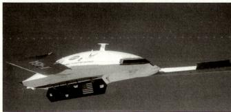
Testflug eines unbemannten Kampfflugzeuges X-45.
