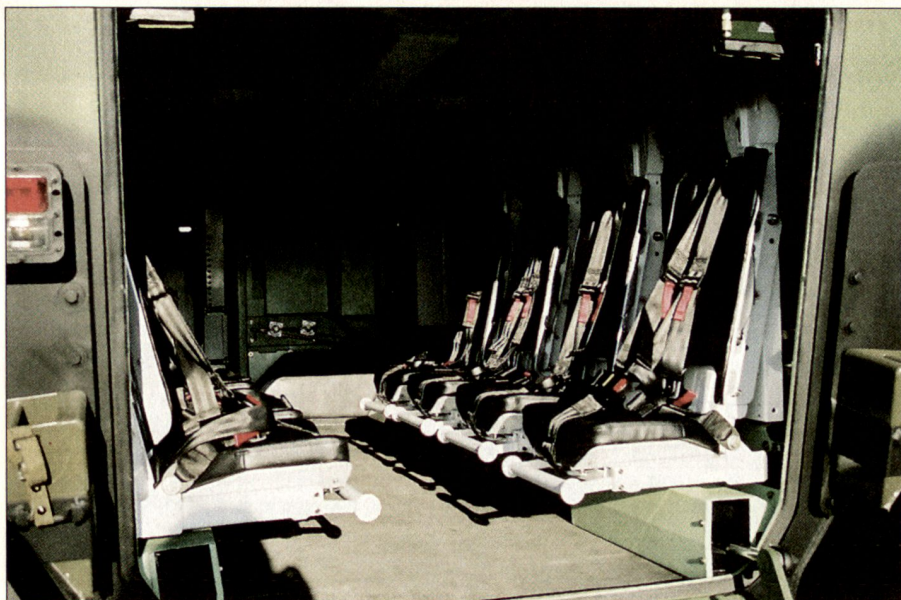
Innenansicht PIRANHA IV mit speziellen Minenschutzsitzen.
