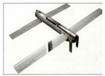
Aufklärungsflugkörper R-90 mit ausgeklappten Flügeln.
