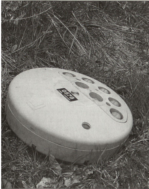
Signaturkörper (Feldkomponente zur Darstellung des Art/Mw-Feuers und zur Wirkungsübertragung) Stand Prototyp.
