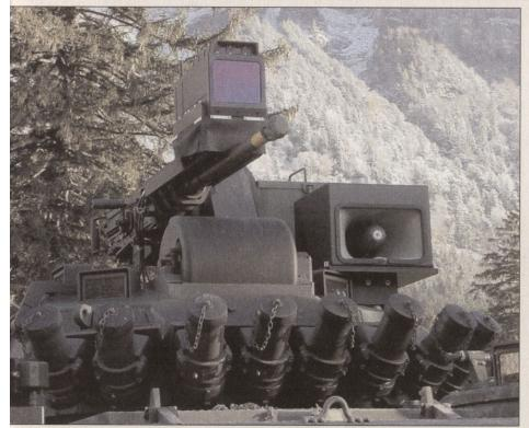
Rad Spz mit aufgebautem LASSIM (Laser-Simulationssystem).
