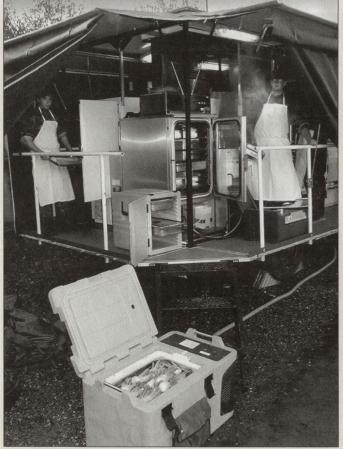
Die Cuisine d'assemblage ist ein zusammengeführtes Küchensystem, das stationär und mobil eingesetzt wird.
