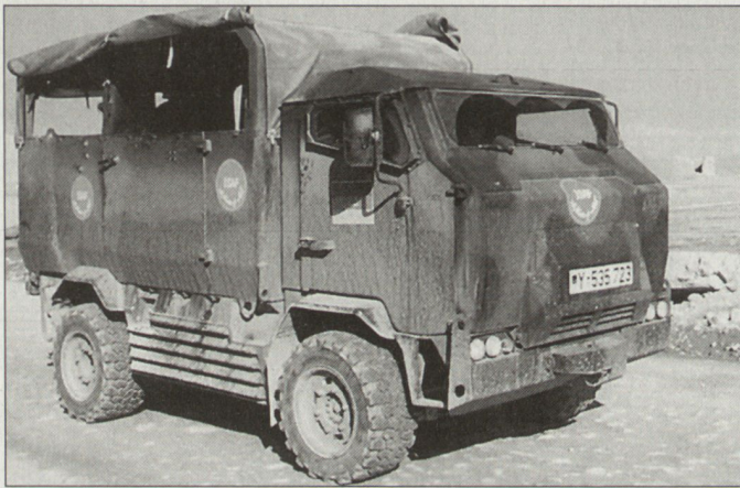
Prototyp des geschützten Geländelastwagens im Einsatz beim deutschen Kontingent in Afghanistan.
