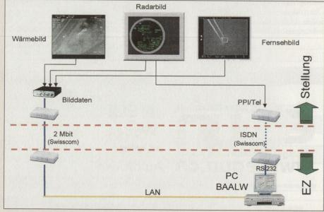
(Abb. 2) Versuchsanordnung WEF 04.
