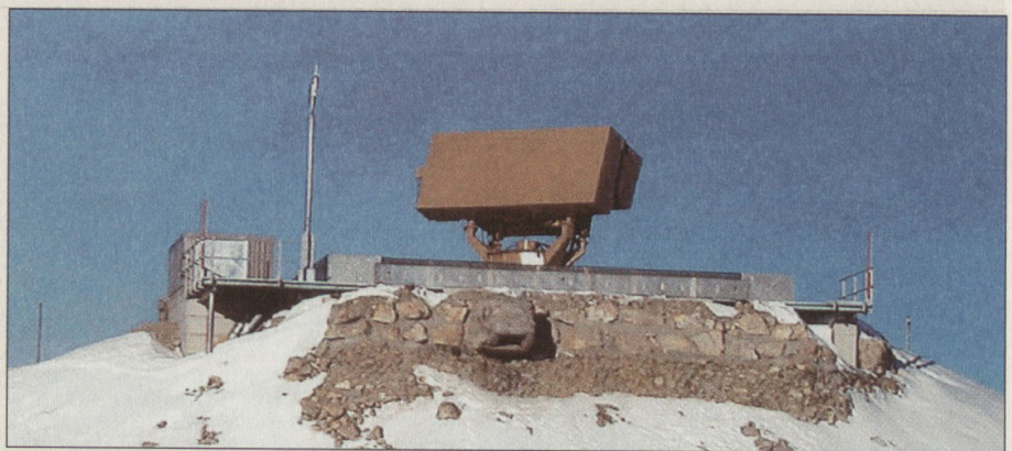
Das so genannte Advanced Radar kann nicht nur für die Rundumüberwachung, sondern auch ganz gezielt für die selektive Verfolgung zugewiesener Ziele eingesetzt werden. Es ist in der Lage, zugewiesene Ziele mit grosser Erneuerungsrate zu vermessen und dadurch die Flugwegbestimmung stark zu verbessern.
