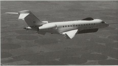
Sentinel R.1 der Royal Air Force in der Erprobungsphase. Die SAR-Antenne ist in der kanuförmigen Verkleidung unter dem Rumpf angebracht, die SAT-Verbindung ist auf dem Rücken angeordnet.
