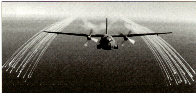
Ablenken IR-gelenkter Flugkörper mittels Leuchtkörpern (Flares) bei einer «Transall».
