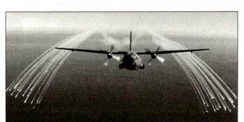
Ablenken IR-gelenkter Flugkörper mittels Leuchtkörpern (Flares) bei einer «Transall».
