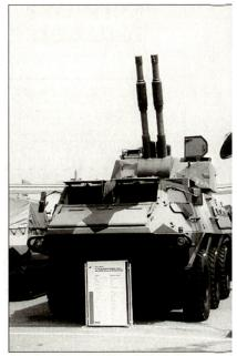
Panzerminenwerfer 120 mm «AMOS» aus finnisch-schwedischer Produktion.
