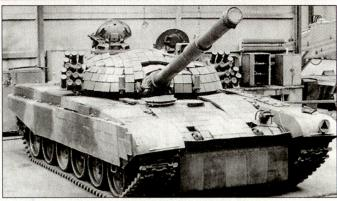
Polnischer Kampfpanzer PT-91M «Twardy», ausgerüstet mit Reaktivpanzerung.
