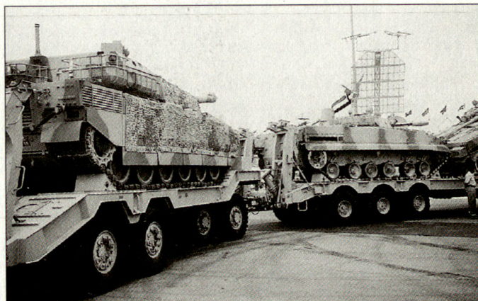
Schwere Lastwagen mit Tiefladeanhänger aus weissrussischer Produktion für die Armee der VAE.
