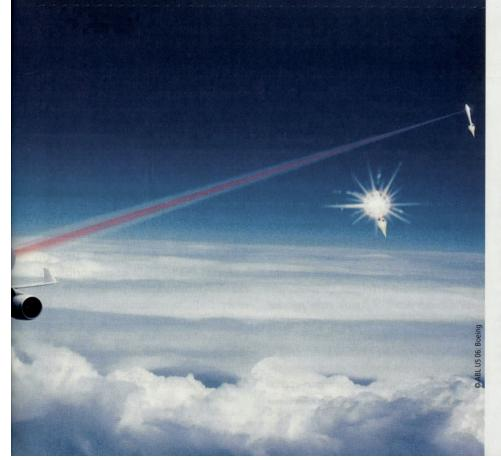
Airborne Laser (ABL): Mit diesem System sollen künftig ballistische Lenkwaffen bereits während der Antriebsphase abgeschossen werden können. Die verhältnismässig geringe Reichweite des ABL dürfte die Einsatzmöglichkeiten jedoch stark einschränken. (Bild: www.airforce-technology.com)
