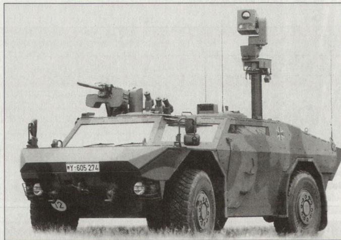
Aufklärungsfahrzeug «Fennek» mit Sensormast.
