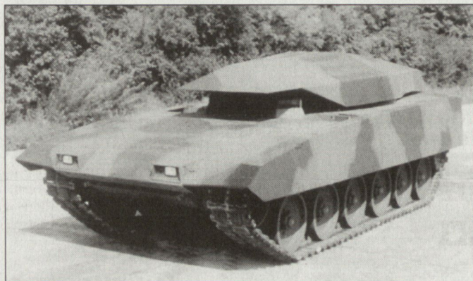
Experimentalwanne Gesamtschutz der Firma Krauss-Maffei Wegmann dient als Versuchsfahrzeug für künftige Kampffahrzeuge.
