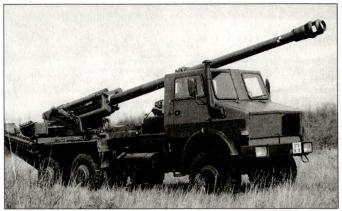
Prototyp des mobilen Artilleriesystems «CAESAR» auf Geländefahrzeug UNIMOG U-2450.
