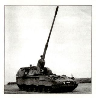
Die 155/52-mm-Panzerhaubitze PzH 2000 ist von Wegmann und MaK aufgrund einer taktischen Forderung der Bundeswehr entwickelt worden.
