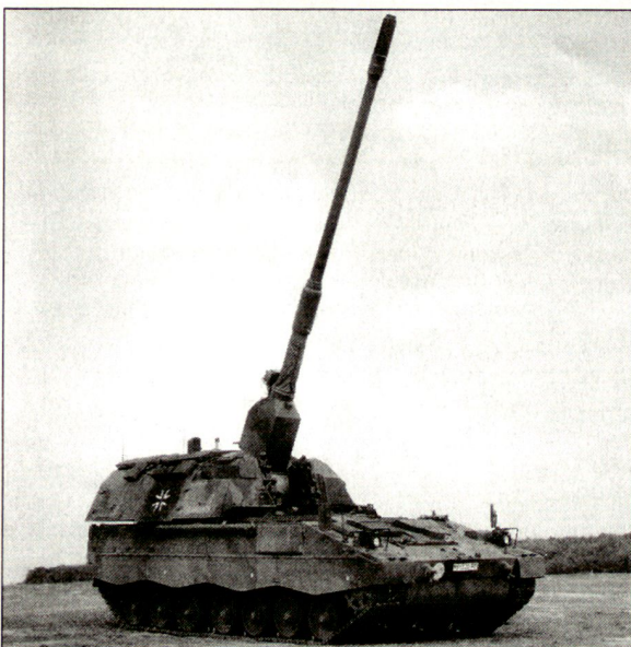
Die 155/52-mm-Panzerhaubitze PzH 2000 ist von Wegmann und MaK aufgrund einer taktischen Forderung der Bundeswehr entwickelt worden.
