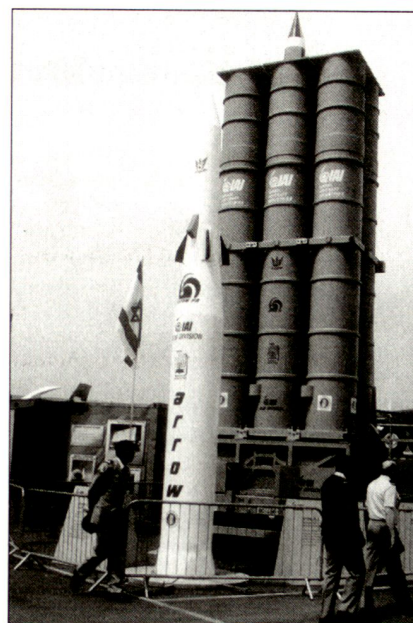
Raketenabwehrsystem «Arrow» (Abwehrlenkwaffe und Abschusscontainer).
