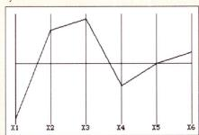
Die sechs parallelen und in gleichmässigem Abstand angeordneten Achsen X1 bis X6. Punkte  $(x_1,...x_n)$  werden dadurch gezeichnet, dass das  $x_i$  auf der entsprechenden i-ten Achse aufgetragen wird. Eine Linie verbindet alle Punkte.
