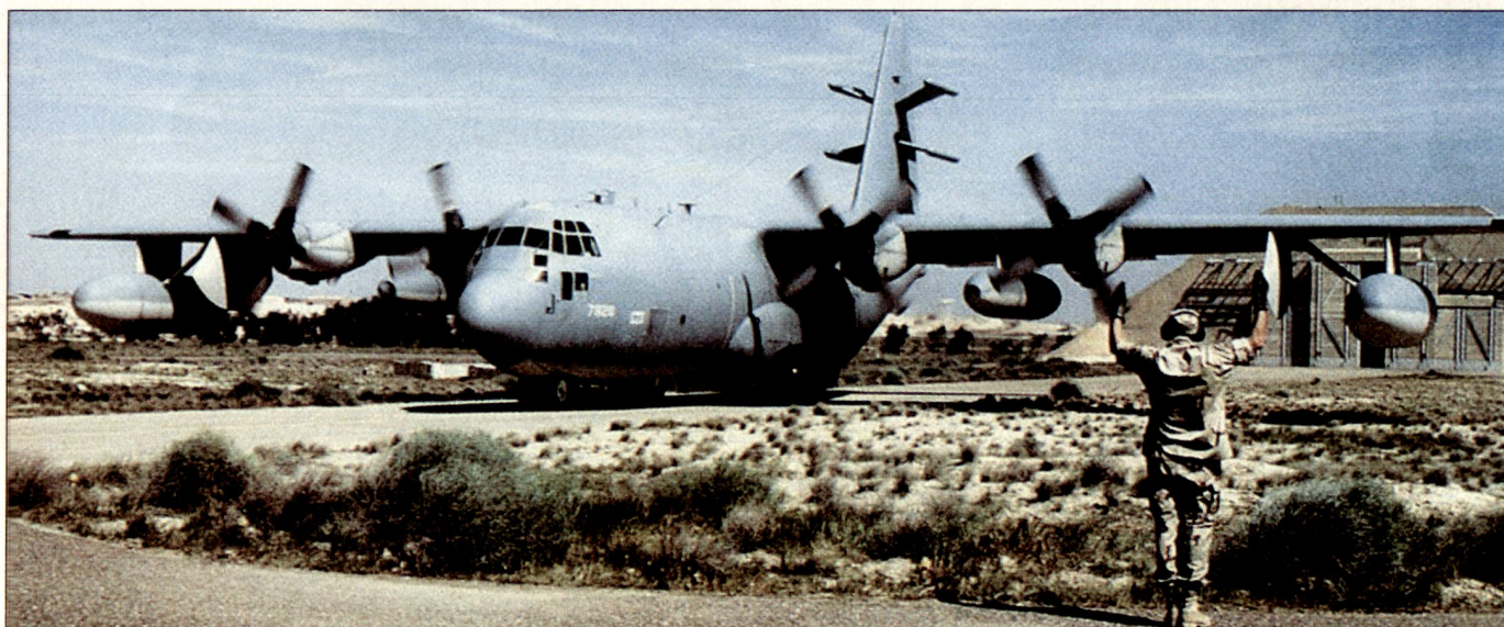
Das EC-130E-Commando-Solo-Flugzeug ist ein fliegender Radio- und Fernsehsender, der in allen gängigen Übertragungsstandards ein weites Gebiet mit eigenen Programmen versorgen kann. Das gewählte Publikum muss aber auf die Sendungen aufmerksam gemacht werden, oder die Sendungen müssen auf bereits etablierten Frequenzen emittiert werden.
