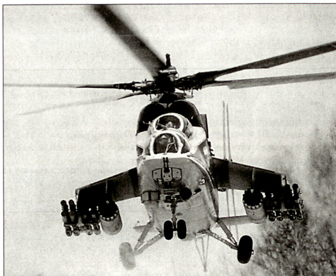
Modernisierter Kampfhelikopter Mi-24 VK-1, ausgerüstet mit PAL und Luft-Luft-Lenk Waffen.
