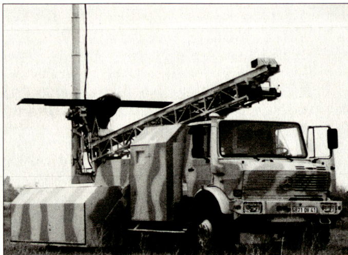
Drohnensystem «Fox» mit einer Reichweite von 150 km.
