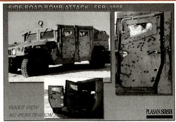
Abb. 1: Geländefahrzeug «Hummer» mit beschusssicherer Zusatzpanzerung.
