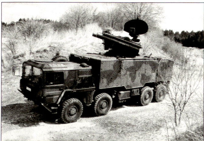
Flab-Lenkwaffensystem «Roland» auf Geländelastwagen MAN.
