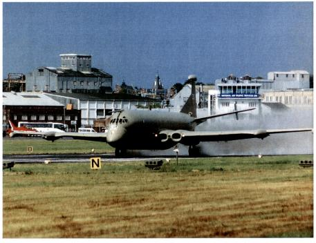
Die aufdatierte Version Nimrod MRA4 mit insgesamt 21 Flugzeugen wird neue Flügel und neue Triebwerke, eine neue Avionik und für die Überwachung eine komplett neue Elektronik erhalten. Dieses Flugzeug wird folgende Daten und Leistungen aufweisen (MR A4):
