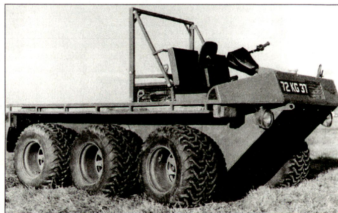
Abwurf-fähiges Transport- und Zugfahrzeug für britische Luftlandtruppen.
