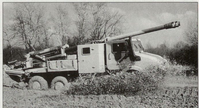
Leichtes mobiles Artilleriesystem «Caesar» vom Kaliber 155/52 mm.
