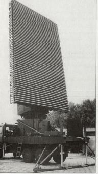
Mobiles 3 D-Radarsystem TRD-1200 aus eigener polnischer Produktion.
