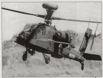
Kampfhelikopter AH-64C «Apache», ausgerüstet mit Radarsystem «Longbow».
