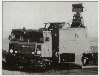
Neuausrichtung der schwedischen Streitkräfte (Bild: Kommandofahrzeug mit 3D-Radar des neuen ASRAD-Systems).
