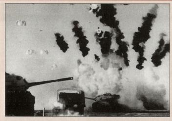
Sensor Fuzed Weapon (SFW); Intelligente Submuniton der neusten Generation. IR-gerichtete «Slugs» durchschlagen die Motorenblöcke von Panzern und anderen Fahrzeugen. dem stellen High-Tech-Systeme wie die BAT oder das LOCAAS einen klaren Schritt in Richtung der Roboterisierung der Kriegführung dar. Ob diese Systeme dann gerade im zivilen Umfeld über die nötige Fähigkeit verfügen werden, zwischen militärischen und zivilen Zielen zu unterscheiden, wird sich erst noch weisen müssen.
