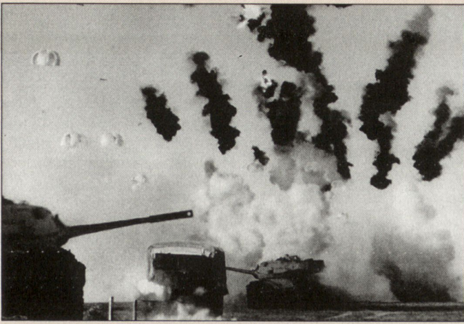
Sensor Fuzed Weapon (SFW); Intelligente Submunition der neusten Generation. IR-gerichtete «Slugs» durchschlagen die Motorenblöcke von Panzern und anderen Fahrzeugen.
