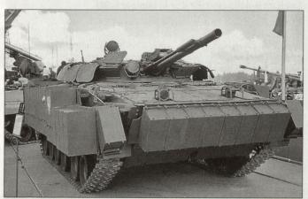
BMP-3 mit aufgebauter Reaktivpanzerung.
