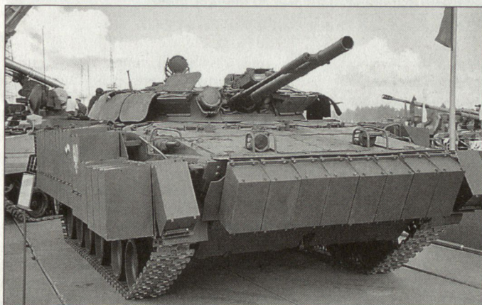
BMP-3 mit aufgebauter Reaktivpanzerung.
