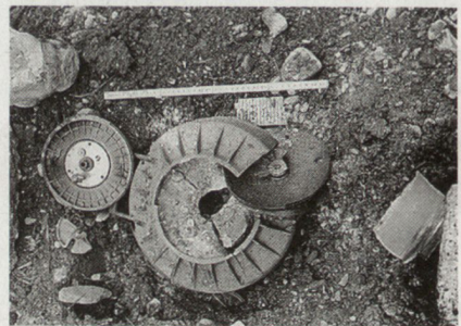
Ergebnis: Zerstörung der Mine ohne detonative Umsetzung. dk
