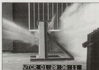
**30-mm-Frangible-Geschoss: Aufnahme 0,03 Sekunden nach dem Durchschlag durch eine Betonwand.**
