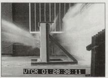
30-mm-Frangible-Geschoss: Aufnahme 0,03 Sekunden nach dem Durchschlag durch eine Betonwand.
