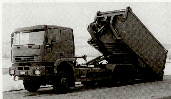
Zivile Lieferwagen; Aufbauwechsel mittels Hubstützen.
