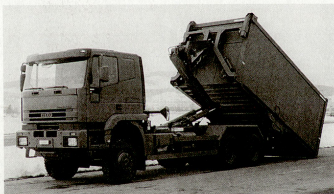
Zivile Lieferwagen; Aufbauwechsel mittels Hubstützen.
