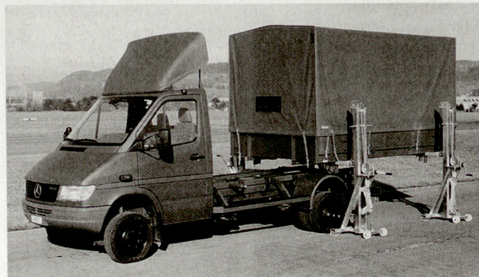
Zivile Lieferwagen; Aufbauwechsel mittels Hubstützen.
