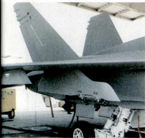
Noch bessere Flugleistungen dank aerodynamischer Waffenaufhängung Links: Swiss Low Drag Pylon. Rechts: US Navy Standard Pylon.
