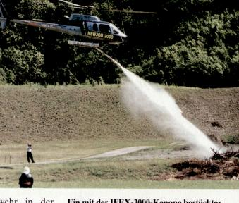
Ein mit der IFEX-3000-Kanone bestückter Helikopter bekämpft wirkungsvoll einen Flächenbrand. Pro Schuss werden 18 Liter Löschwasser innerhalb von 200 Millisekunden abgefeuert. (Bild: Hunger)
