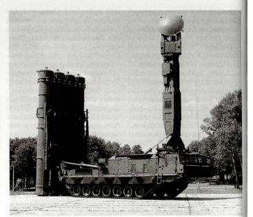
Werferfahrzeug des russischen Flab- und Flugkörperabwehrsystems S-300V.
