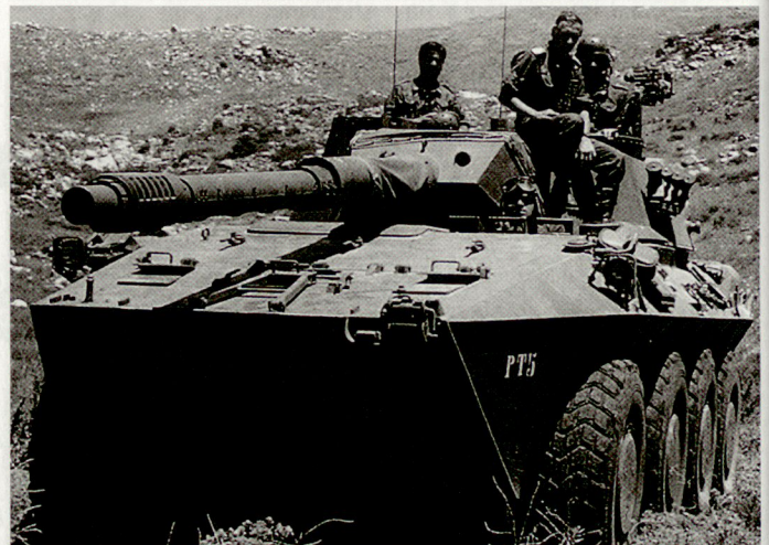
Kampffahrzeug «Centauro», ausgerüstet mit Kanone 105 mm zur Unterstützung der «Extraction Force».
