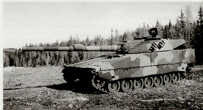
Prototyp des leichten Panzers CV-90120 mit Kanone 120 mm. ■
