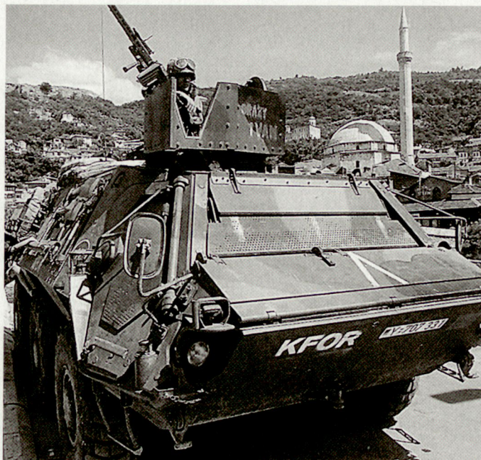
Transportpanzer «Fuchs», versehen mit Zusatzpanzerungen.
