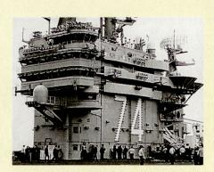
In der US Naval Base San Diego konnte einer der neusten Flugzeugträger, die John C. Stennis, CVN 74 (CVN = Carrier Vessel Nuclear), besichtigt werden. Der Träger wird von zwei Nuklear-Reaktoren angetrieben, ist 332 m lang, 74 m hoch, wiegt 97000 Tonnen, verfügt über ein Flugdeck von 78 m Breite und weist eine Besatzung von 6200 Personen auf. Er ist bestückt mit über 80 Flugzeugen (davon 36 F/A-18) und Helikoptern. Der
