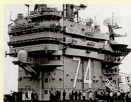
In der **US Naval Base San Diego** konnte einer der neusten Flugzeugträger, die **John C. Stennis, CVN 74** (CVN = Carrier Vessel Nuclear), besichtigt werden. Der Träger wird von zwei Nuklear-Reaktoren angetrieben, ist 332 m lang, 74 m hoch, wiegt 97000 Tonnen, verfügt über ein Flugdeck von 78 m Breite und weist eine Besatzung von 6200 Personen auf. Er ist bestückt mit über 80 Flugzeugen (davon 36 F/A-18) und Helikoptern. Der
